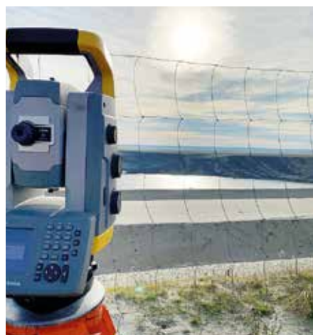
Wasserspiegelbestimmung am Nordrandschlauch des zukünftigen Cottbusser Ostsees
