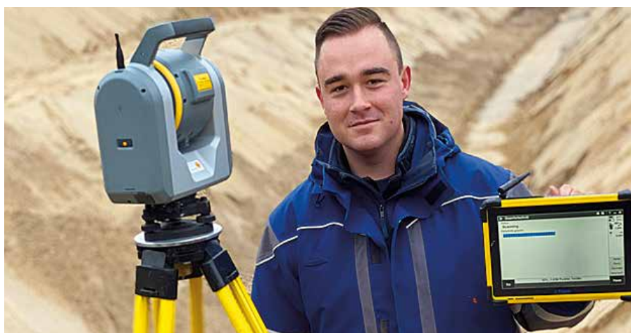
terrestrisches Laserscanning zur Volumenermittlung an der Aschedeponie Jänschwalde II
